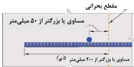
شکل ۲۱-۶ طول گیرایی شبکه آرماتور سیمی جوش شده
